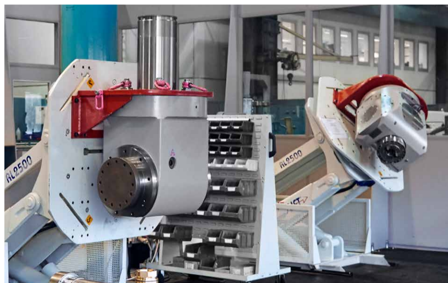
お客様の要求条件に合わせる：ミーリングヘッド、自社制作
