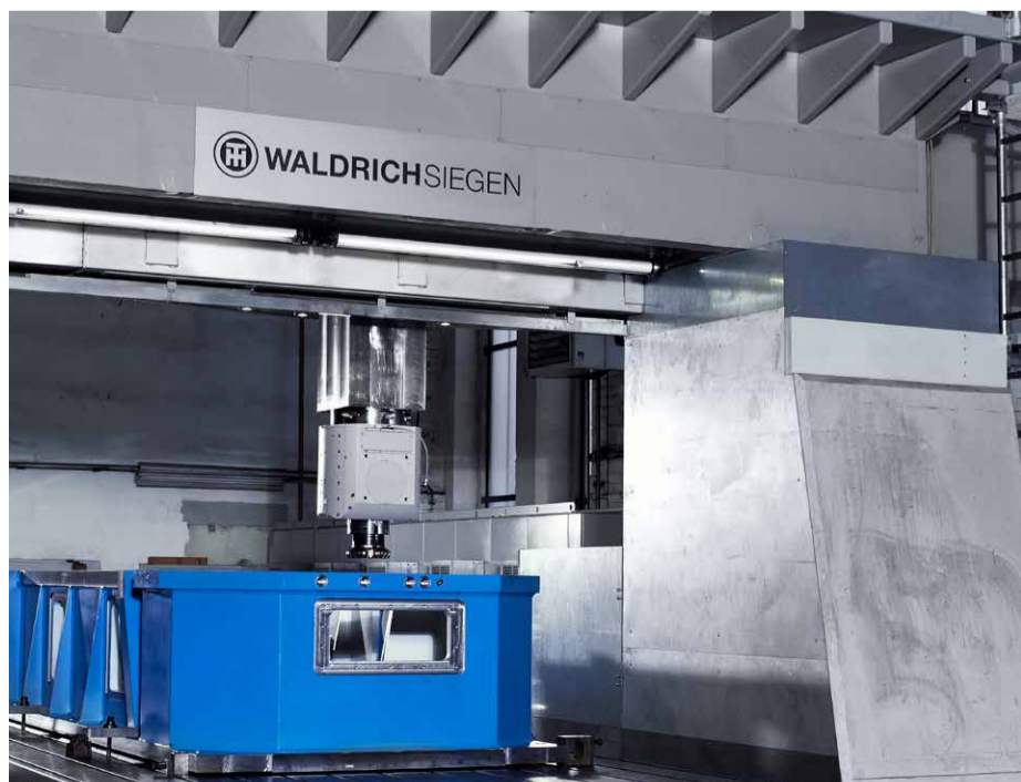
オプションのコンクリート柱は機械の剛性をさらに高めました
